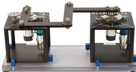
Fig. 2.2 Quanser- 2 DoF Robot
